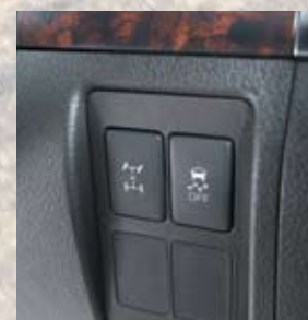
Двигатель запускается кнопкой, рядом — поворотная ручка демупльтипликатора. Под ними — кнопки включения межосевой блокировки и отключения системы стабилизации
