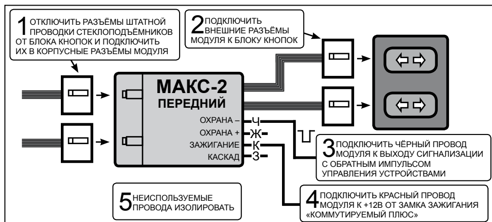
Рисунок 2. Схема подключения модуля МАКС к сигнализации с обратным импульсом на выходе управления внешними устройствами
